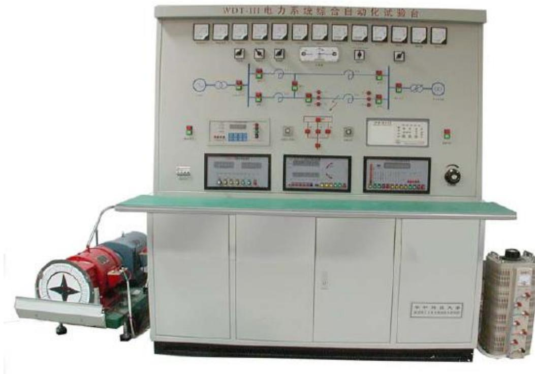
附图1 电力系统综合自动化试验台外形图
